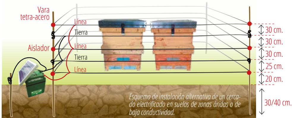
Cuando el suelo es muy seco o de muy baja conductividad, para asegurar el funcionamiento se puede hacer una instalación alternativa consistente en colocar dos líneas de cable de tierra alternadas con tres líneas de cable conductor en el propio cercado, de forma que el oso cierra el circuito y recibe una descarga cuando toca simultáneamente un cable conductor y un cable de tierra.
